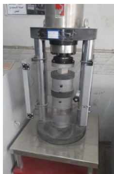
Fig. (1-a) :Compressive Strength Machine Fig.(1-b) :Vicat Apparatus
